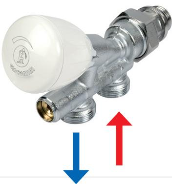
Termostatická jednovtoková armatura pro jednotrubkové systémy s integrovaným regulačním šroubením. Vyrobeno z mosazi, chromováno. Samotěsnící kroužek závitu. Pro připojení měděných trubek se použije adaptér R178 nebo R178C, pro plastové trubky R179 nebo R179AM. Součástí dodávky je plastový injektor R171P ø12 mm o délce 450 mm.
