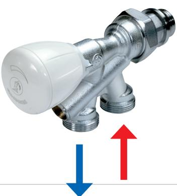
Termostatická jednovtoková armatura pro jednotrubkové systémy s integrovaným regulačním šroubením. Vyrobeno z mosazi, chromováno. Samotěsnící kroužek závitu. Pro připojení měděných trubek se použije adaptér R178 nebo R178C, pro plastové trubky R179 nebo R179AM. Součástí dodávky je plastový injektor R171P ø12 mm o délce 450 mm.
