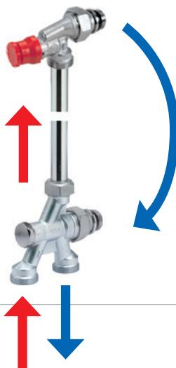
Radiátorová sestava s dvouregulačním termostatickým ventilem a regulačním šroubením pro dvoutrubkový systém. Samotěsnící kroužky závitů. Propojovací chromovaná trubka R194 ø16mm není součástí dodávky. Pro připojení měděných trubek se použije adaptér R178 nebo R178C, pro plastové trubky R179 nebo R179AM.
