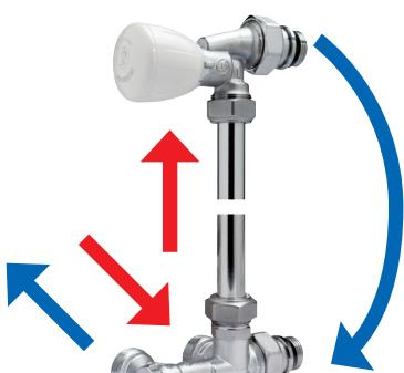
Radiátorová sestava rohová, s termostatickým ventilem a regulačním šroubením pro jednotrubkový systém. Samotěsnící kroužky závitů. Lze připojit na těleso zleva i zprava. Propojovací chromovaná trubka R194 ø16mm není součástí dodávky. Pro připojení měděných trubek se použije adaptér R178 nebo R178C, pro plastové trubky R179 nebo R179AM.
