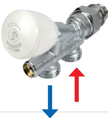
Termostatická jednovtoková armatura pro dvoutrubkové systémy s integrovaným regulačním šroubením. Vyrobeno z mosazi, chromováno. Samotěsnící kroužek závitu. Pro připojení měděných trubek se použije adaptér R178 nebo R178C, pro plastové trubky R179 nebo R179AM. Součástí dodávky je plastový injektor R171P ø12 mm o délce 450 mm.
