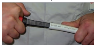
3. Vykalirování a ořezání vnitřních hran trubky.
