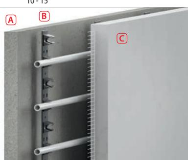
Montáž stěnového vytápění se provádí za pomocí instalačních lišt W389, které se na stěnu připevňují např. plastovými hřebi W983-6 tak, aby byla v celé své délce pevně přitisknuta na stěnu.
