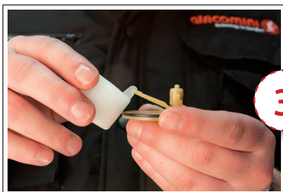
Plovák přetočte vzad a vyhákněte z vahadla
