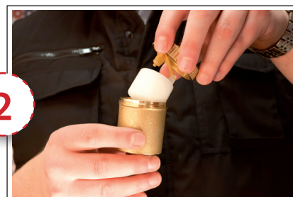
Vyjměte vnitřní mechanismus ventilu
