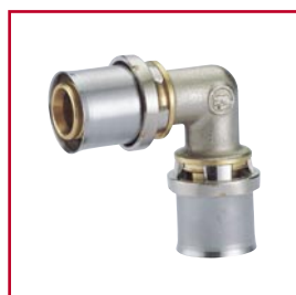
RP122 Lisovací kolínko pro trubky GIACOTHERM , GIACOFLEX , polybutylén, PEX-Al-PEX niklované
