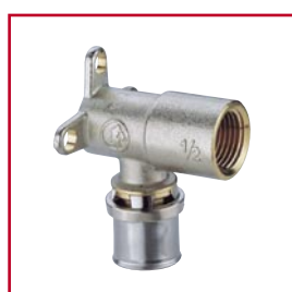
RP139 Lisovací nástěnka s vnitřním závitem pro trubky GIACOTHERM , GIACOFLEX , polybutylén, PEX-Al-PEX niklované
