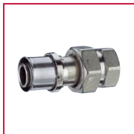
RP18 Lisovací šroubení přímé, 3-dílné s vnitřním závitem, pro trubky GIACOTHERM, GIACOFLEX, polybutylén, PEX- Al-PEX niklované
