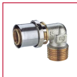
RP127 Lisovací kolínko s vnějším závitem pro trubky GIACOTHERM , GIACOFLEX , polybutylén, PEX-Al-PEX niklované
